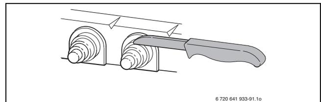
Fig. 48 Cut off grommets
